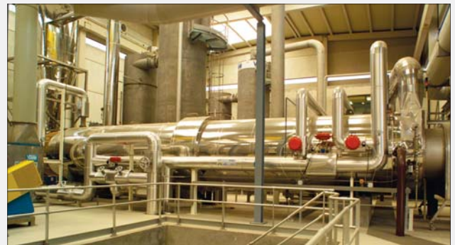
可实现高含水废弃物干燥的涡轮薄层干化工艺与设备
