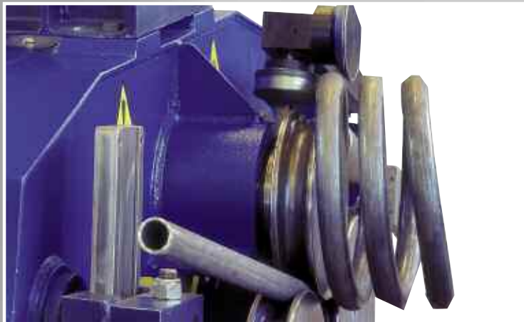
Estensione guida laterale per spirali di piccolo diametro Rulli sagomati per tubo
