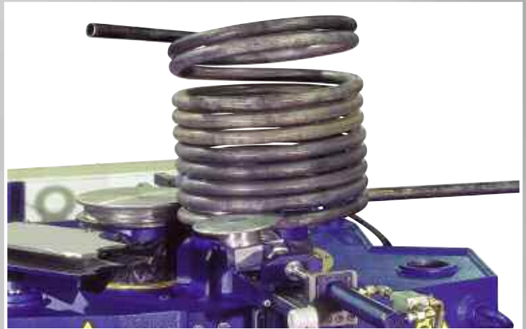
Macchina speciale per spirali Special machine for spirals Sondermaschine für Spiralen Máquina especial para el curvado de espirales Machine spéciale pour spirales
