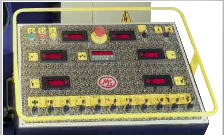
Visualizzatori di quota su tutti i movimenti a richiesta Digital readouts on all movements (upon request). Digitalanzeigen für alle Verstellwege (Option) Visualizadores digitales de cota para todos los movimientos (bajo pedido) Visualiseurs digital des cotes sur toutes les mouvements
