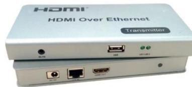
HX-HDMI120MU 是一款架構於 TCP/IP 技術的 HDMI KVM+IR 訊號延長器，解析度最高支援 1080P，設備使用一條 CAT6 網路線能將訊號延長 120M。傳送端除了能接一般 HDMI 輸出的 PC 外，也可應用於一般 1080P 多媒體撥放裝置、DVD 等撥放源。設備傳送加接收為一套，可做點對點的訊號延伸。基於 TCP/IP 架構下，設備可經由交換機設備來做 HDMI 多點影音畫面傳送，而多點接收端可透過 USB 介面來控制傳送端的設備。可透過級聯路由器方式不斷擴展延伸，最大支持 254 個點。
