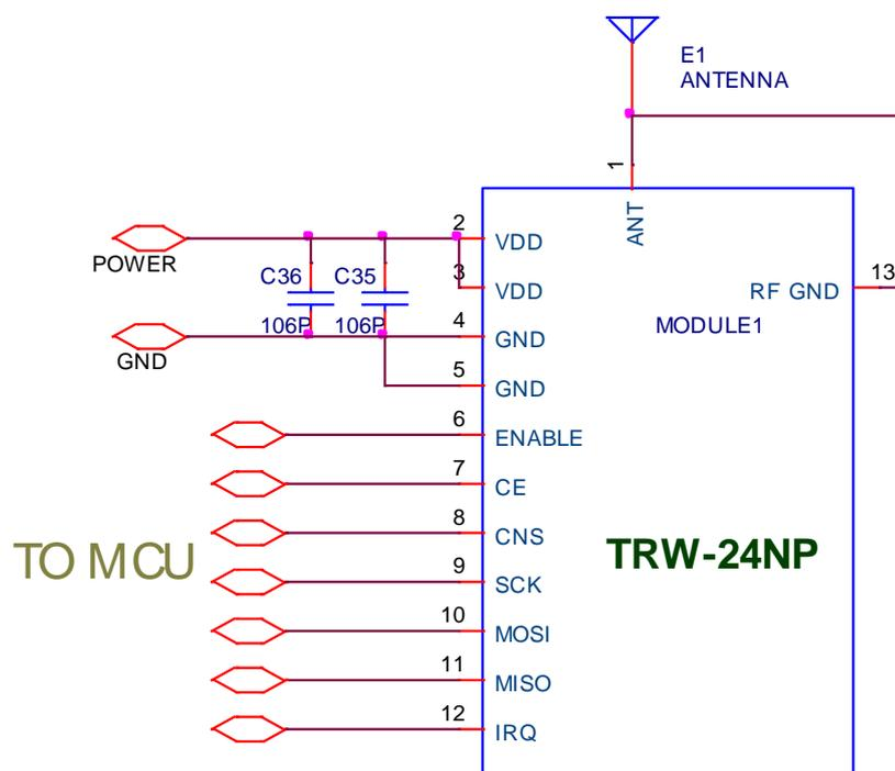
2. 模組底部基板最好不要設計數位信號，以避免 EMI 傳導到 RF 模組內。
