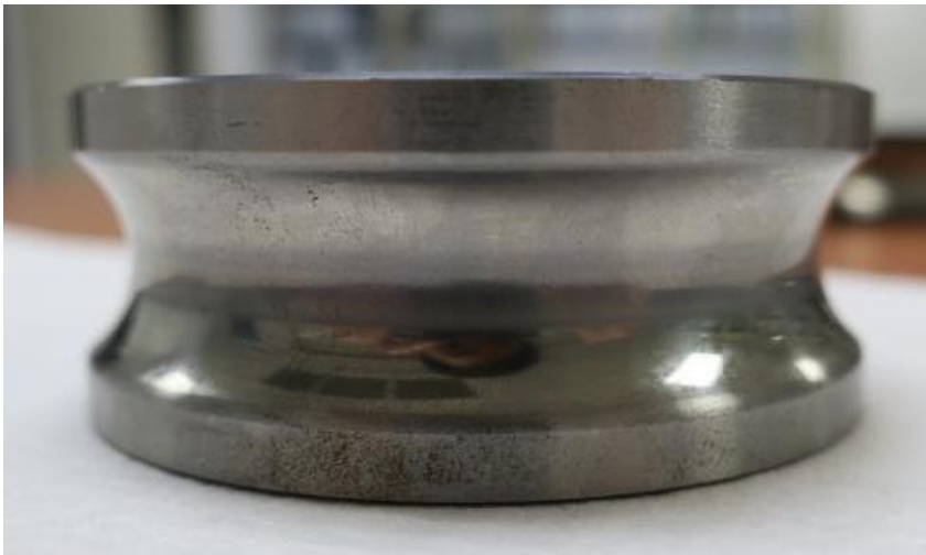
內圈軌道磨耗(霧面)
