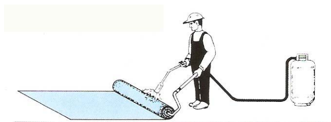
圖三A、一面燒烤、一面鋪設熱熔式防水膜。
