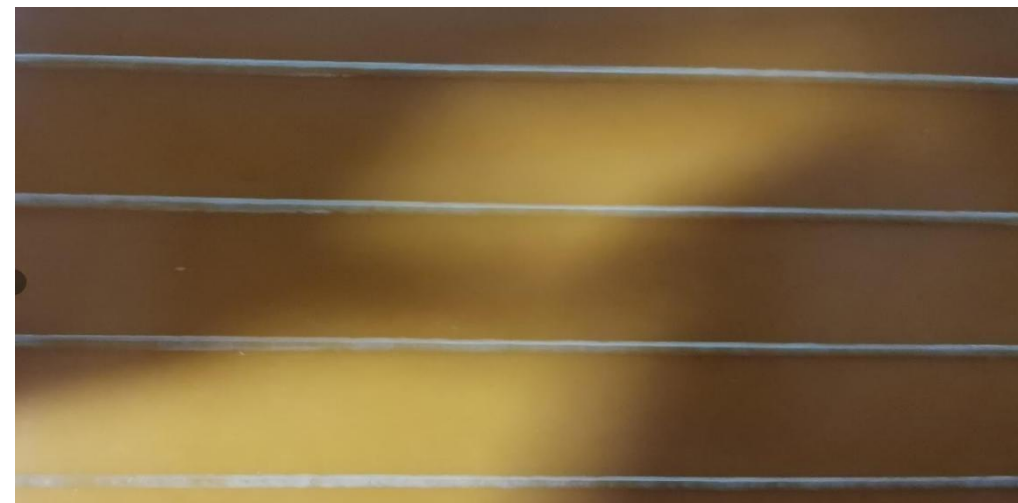
1mm大膠量UV點膠，滿足寬扁要求 (膠寬0.1mm，膠高0.25mm)
