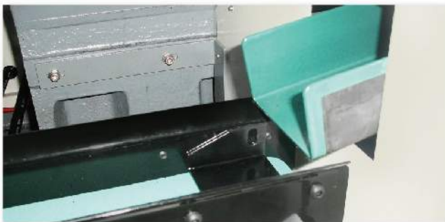
▲ 成品取料裝置含輸送帶(選配) Parts catcher and conveyor(opt)
