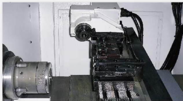
▲ 上方單軸側銑裝置(ER-20/ER-25) Single shaft side milling device-top side(ER-20/ER-25)
