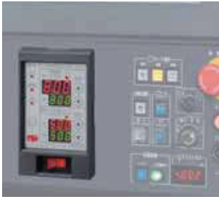
範例1 利用附屬的面板固定零件使TRC202嵌入於控制盤內
